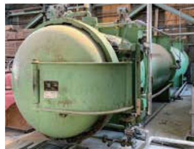
不燃処理装置
